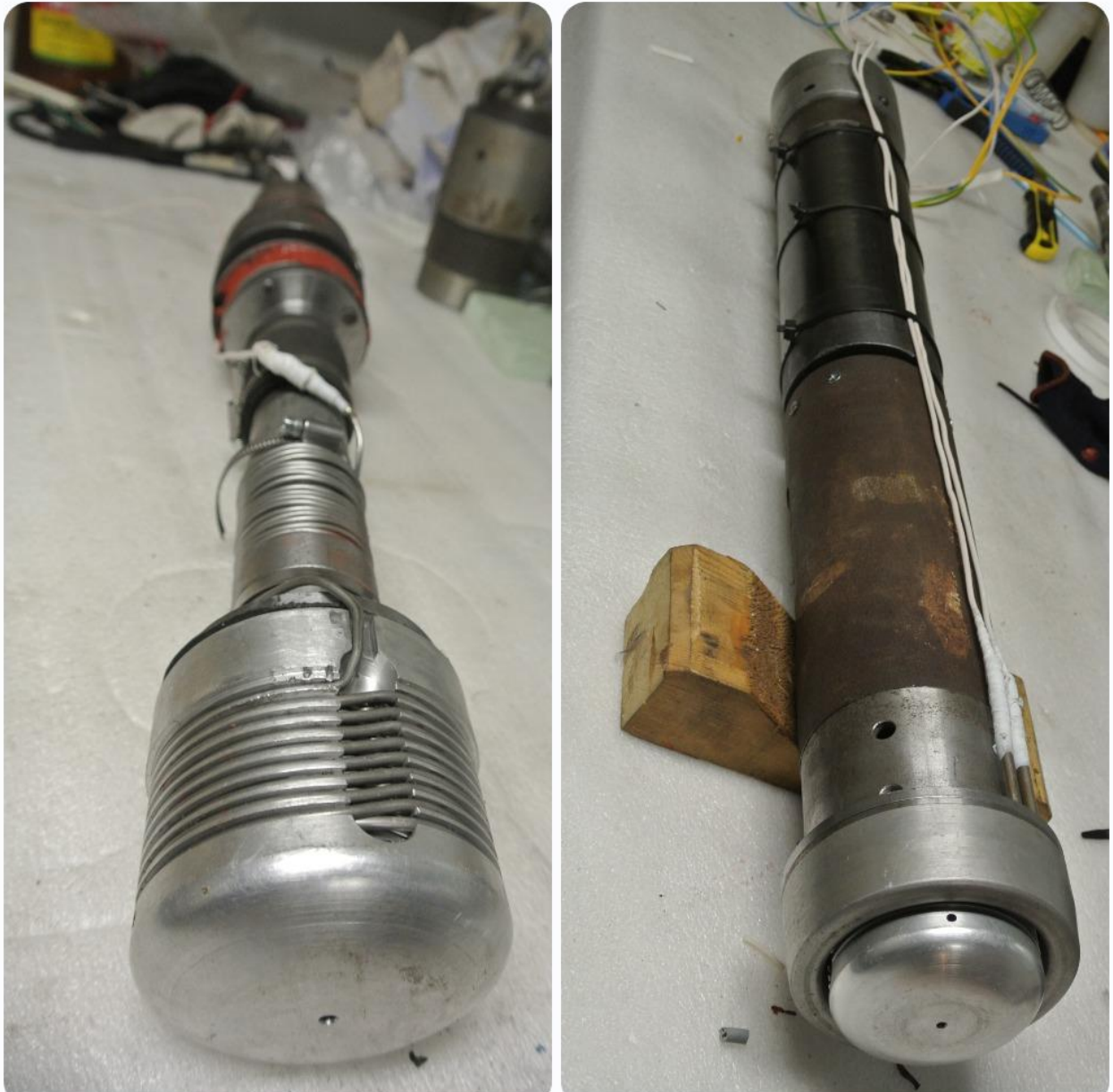
Рисунок 3.3 – Модели термогидравлического бурового снаряда-расширителя.
