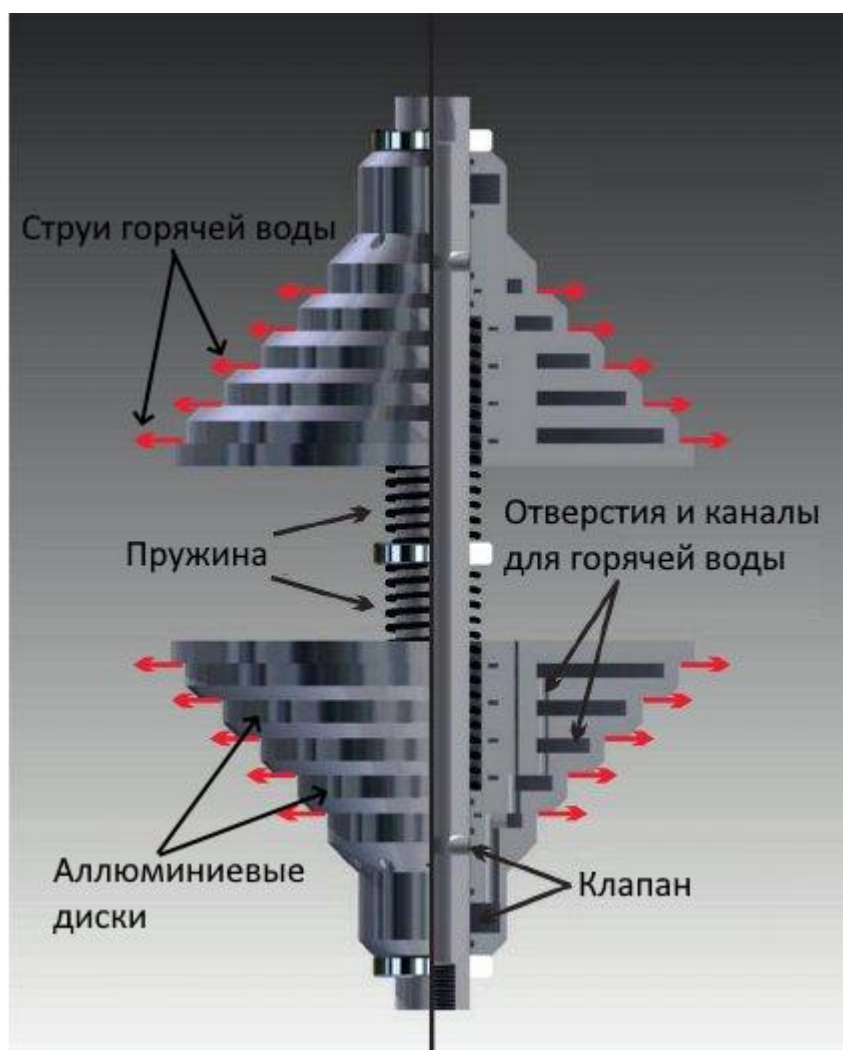
Рисунок 1.12 – Расширитель, включенный в состав КНБК. Иллюстрация внешней поверхности расширителя слева и в поперечном сечении справа. Красными стрелками указаны места, где из расширителя может разбрызгиваться вода, а клапан показан в выключенном положении.
