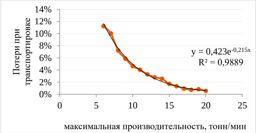
Рисунок 6 – График зависимости доли потерь времени при транспортировке от максимальной производительности перегружателя
