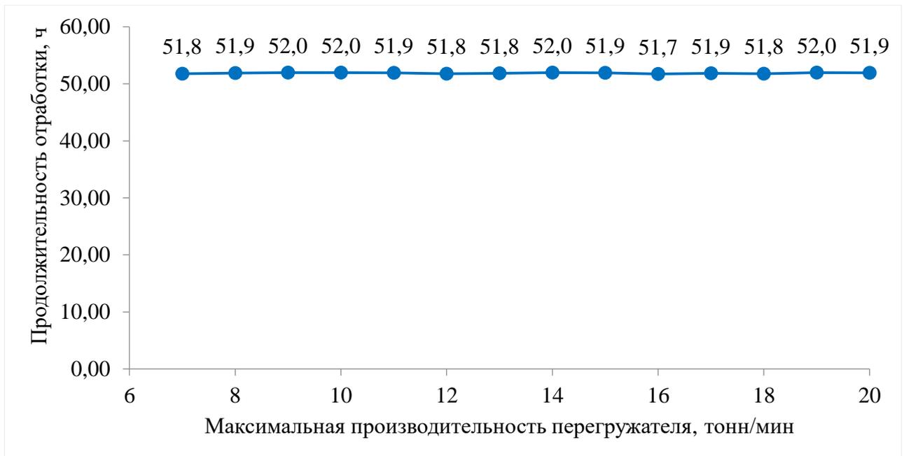
Рисунок 21 – Результаты варьирования параметра максимальной производительности бункера в оптимизационном эксперименте (составлено автором)
