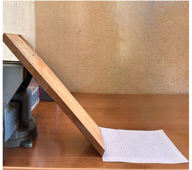
Рисунок 3.9 – Схема и стенд для проведения испытаний по определению коэффициента восстановления в паре «керамзит-керамзит» (составлено автором)
