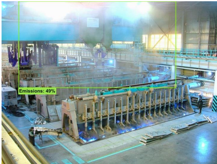
Рисунок 7 – Распознавание видимого выброса в реальном электролизном цехе при помощи нейронной сети, исполняемой на NVIDIA Jetson Nano
