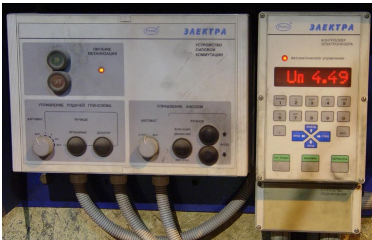
Рисунок 2.9 – Контроллер электролизера АСУ ТП «ЭЛЕКТРА» (справа) и устройство силовой коммутации (слева). Источник: материалы автора.
