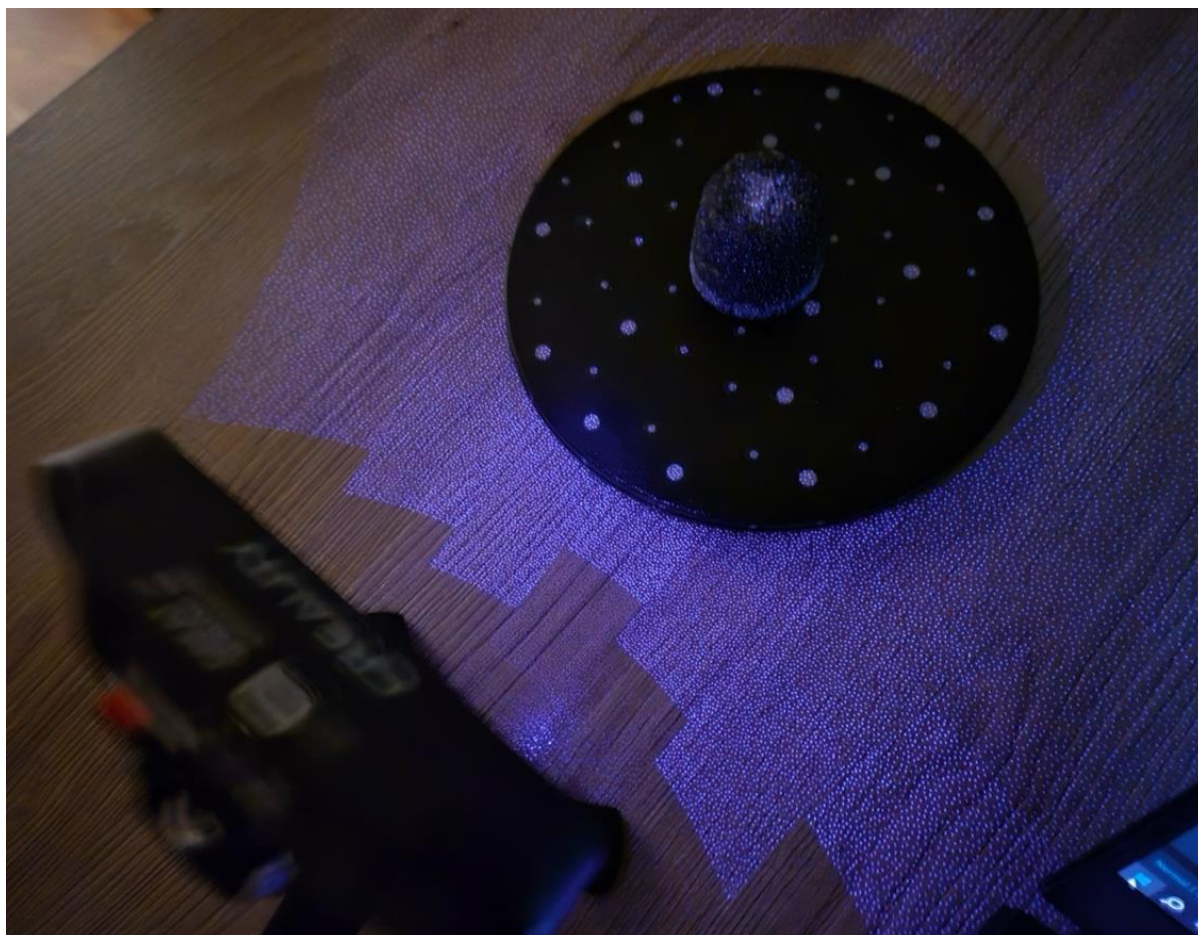
Рисунок 3.16 – Облако точек инфракрасного света, формируемое источником инфракрасного излучения 3D-сканера в процессе оптического сканирования электрода после электролиза для определения его остаточного объёма.
