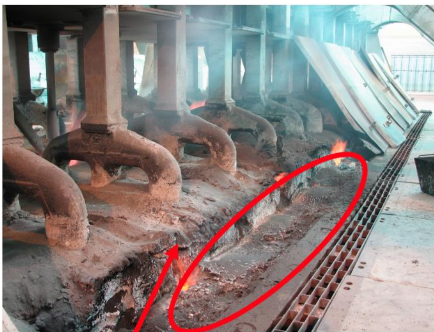
Рисунок 3.47 – Корка криолито-глиноземного расплава. Источник: [72]
