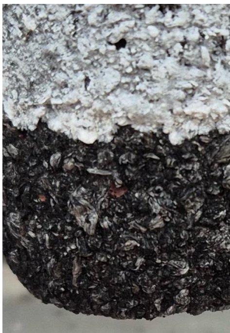
Рисунок 3.40 – Графитизированный анод из нефтяного кокса. Источник: материалы автора.
