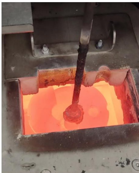
Рисунок 3.24 – Фото погруженного анода в расплав КГР.
