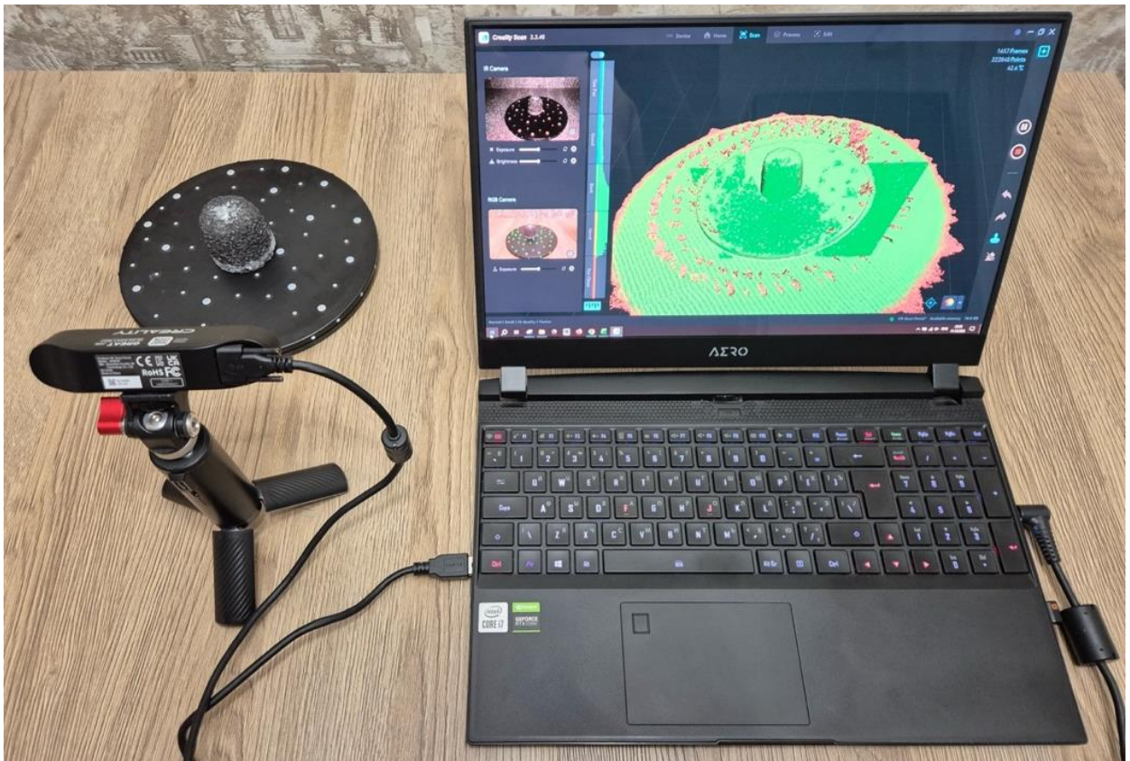
Рисунок 3.15 – Процесс сканирования электрода с использованием 3d сканера Creality CR-Scan Ferret. Источник: материалы автора.
