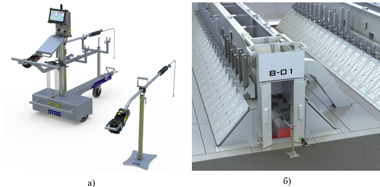
Рисунок 2.6 – Портативная установка платформа STARprobe для определения технологических параметров процесса электролиза криолито-глиноземного расплава а) – внешний вид портативной платформы; б) фото в процессе измерения технологических показателей. Источник: [91]
