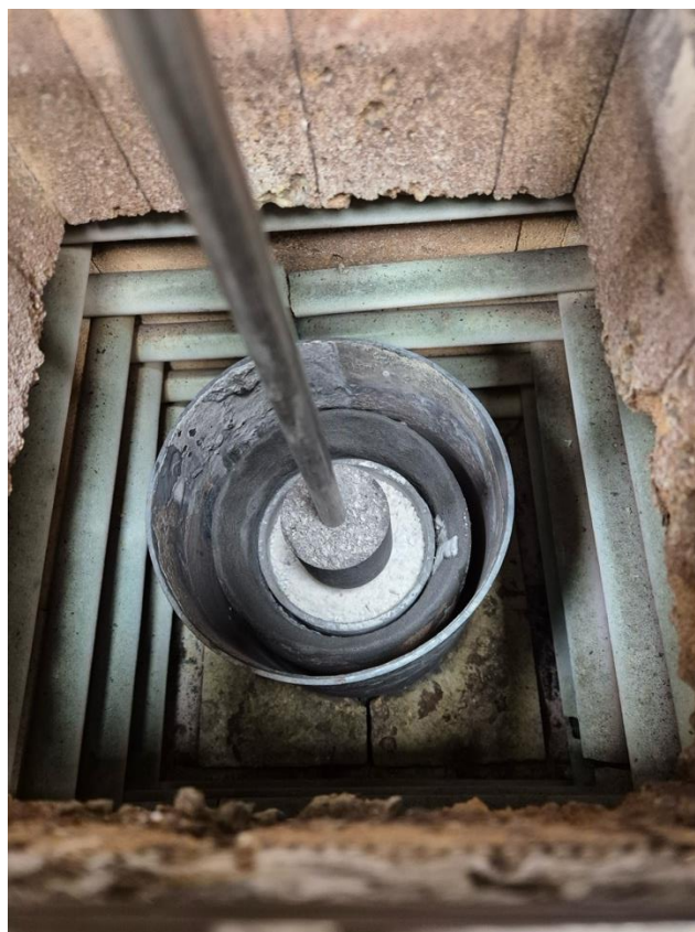
Рисунок 3.5 – Процедура центровки стенок графитового тигля относительно анода. Источник: материалы автора.
