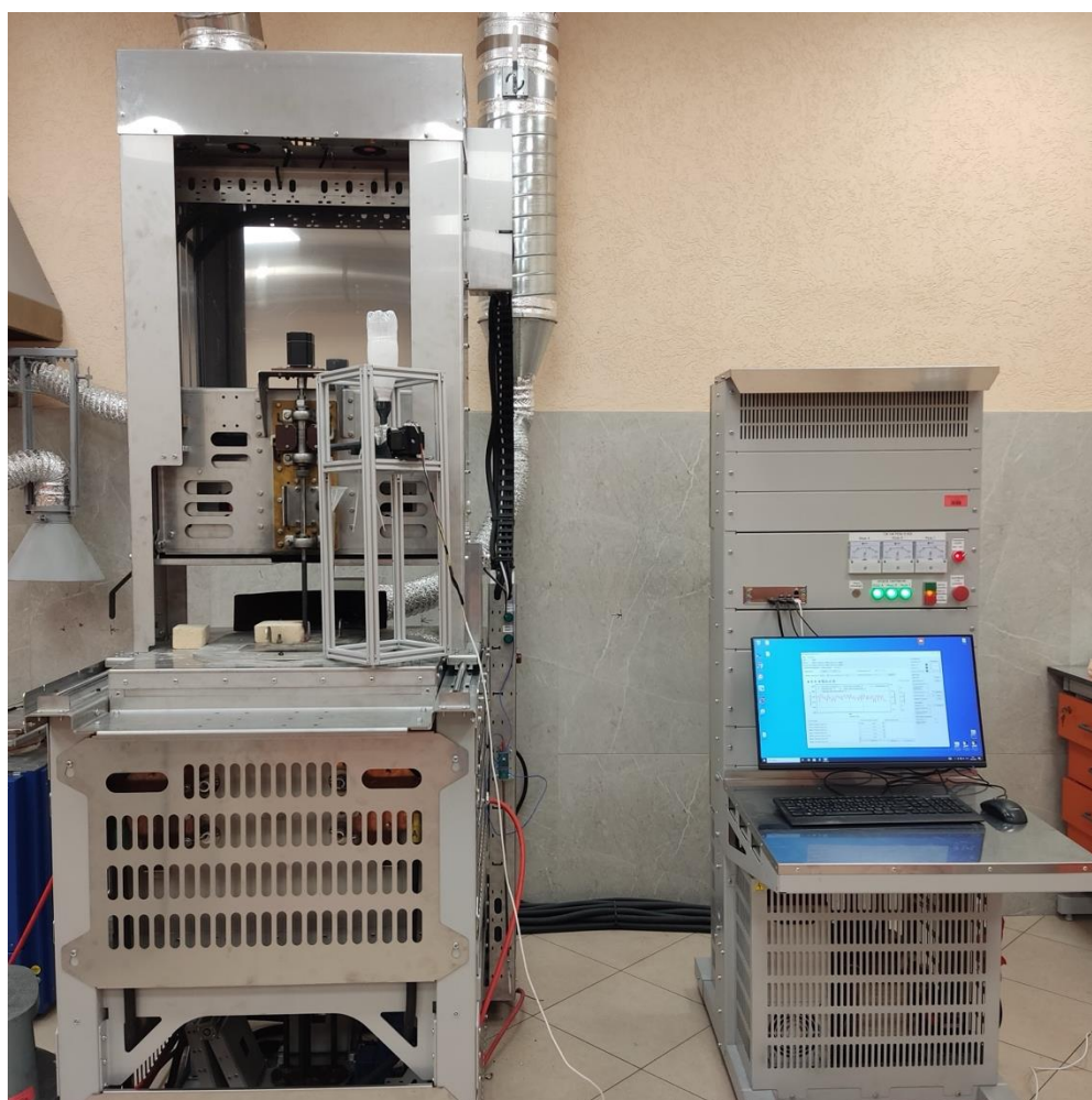
Рисунок 3.1 – Установка для электролиза расплавов и испытания материалов в условиях электролиза. Источник: материалы автора
