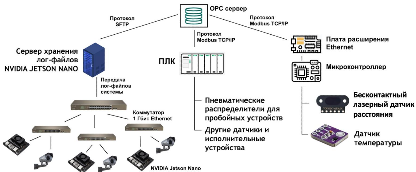
Рисунок 4.10 – Структурная схема системы мониторинга электролизера
