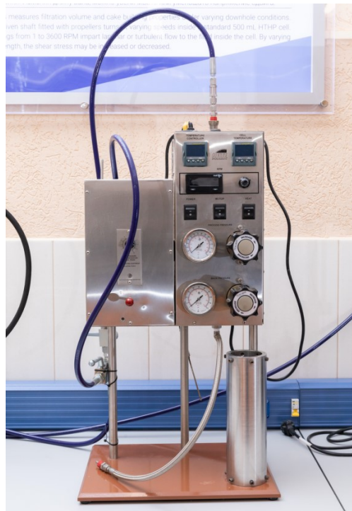
Рисунок 2.6 – Динамический фильтр-пресс НТНР (OFITE)
