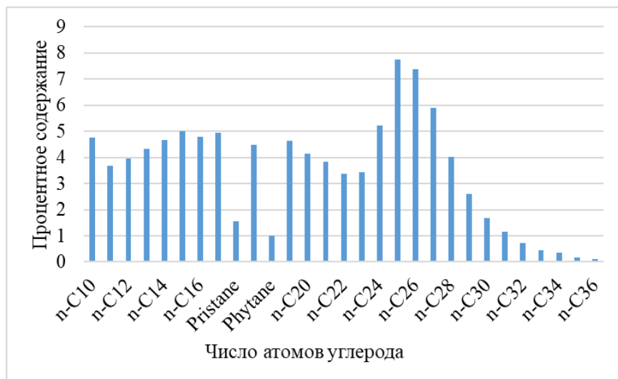
Рисунок 4.1.1 – Результаты хромато-масс-спектрометрического анализа углеводородов палеозойской залежи Урманского НГКМ (скважина 128, пласт М-М 1 ) (составлено автором)
