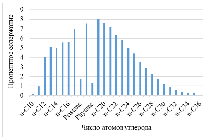
Рисунок 4.1.3 – Результаты хромато-масс-спектрометрического анализа углеводородов палеозойской залежи Арчинского НГКМ (скважина 1011, пласт М+М 1 ) (составлено автором)
