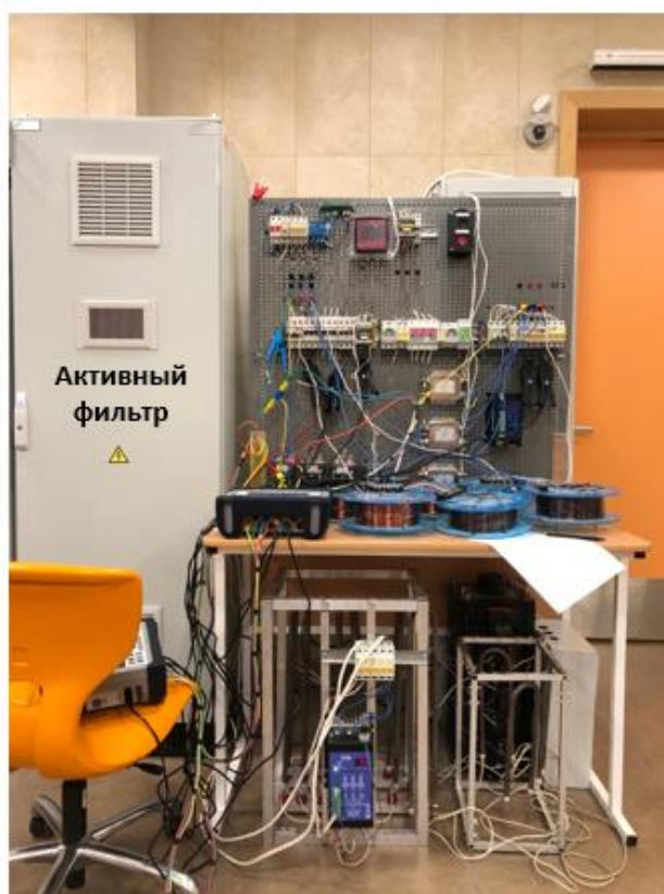
Рисунок 4.15 – Лабораторная установка с активным фильтром гармоник (фото автора)
