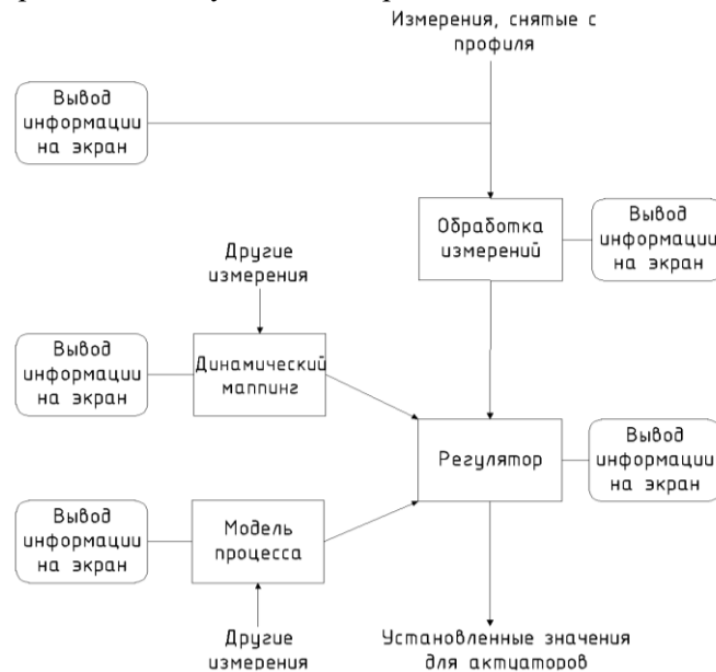
Рисунок 2 - Структура существующей системы управления бумагоделательными машинами для одного из параметров
