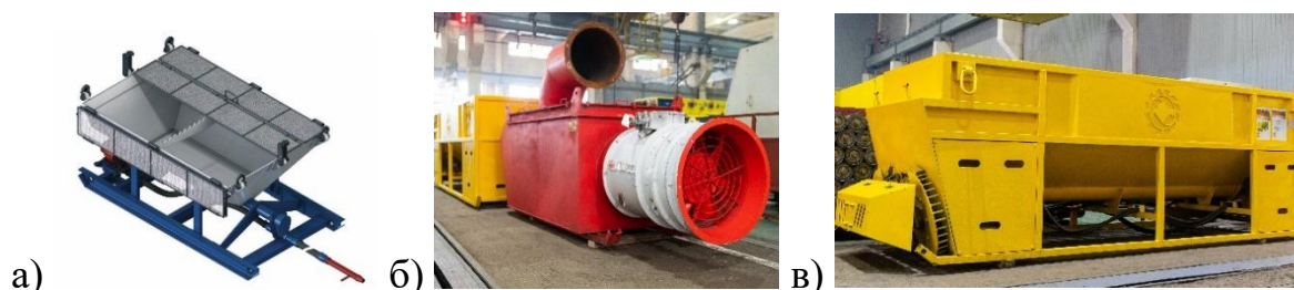
Рисунок 1.8 – Осланцеватели производства России: а) осланцеватель ОПШ-01; б) осланцеватель типа УО; в) осланцеватель типа ОГ-1 «БУРАН»; [46]
