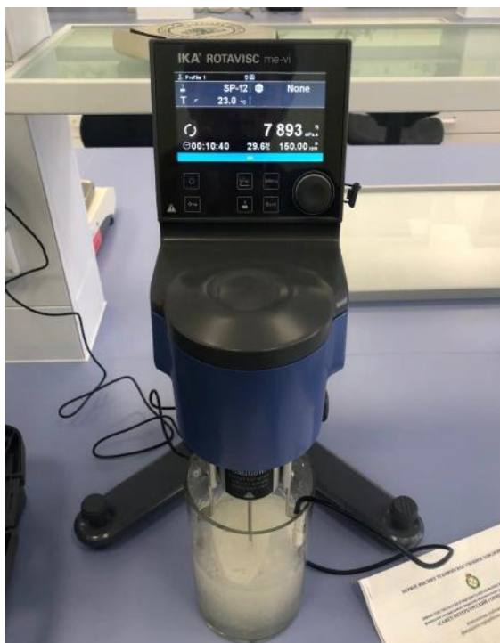
Рисунок 2.12 – Измерение вязкости с помощью вискозиметра IKA ROTAVISC me-vi
