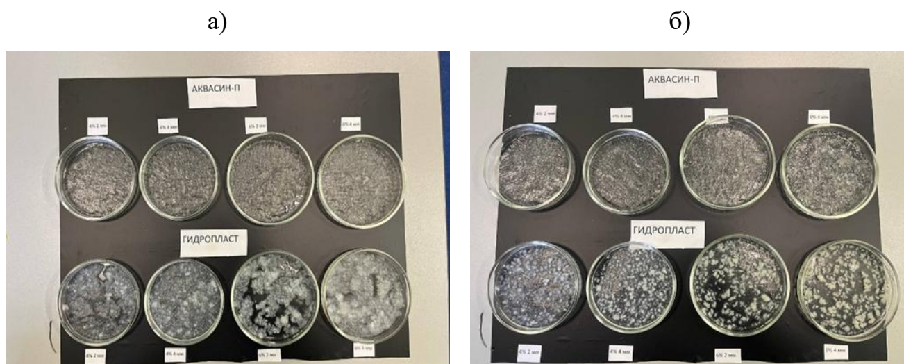
Рисунок 2.3 – а) растворы гидрогелей сразу после добавления воды; б) растворы гидрогелей через сутки после добавления воды
