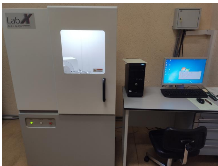
Рисунок 2.4 – Рентгеновский порошковый дифрактометр XRD-6000
