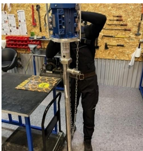
Рисунок 4.6 – Бочковой насос винтового типа
