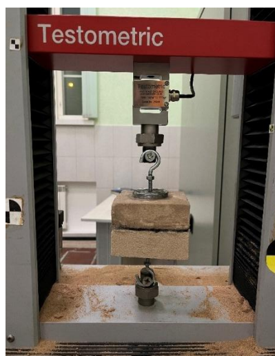
Рисунок 2.8 – Испытания на отрыв на установке Testometric M350-5AT
