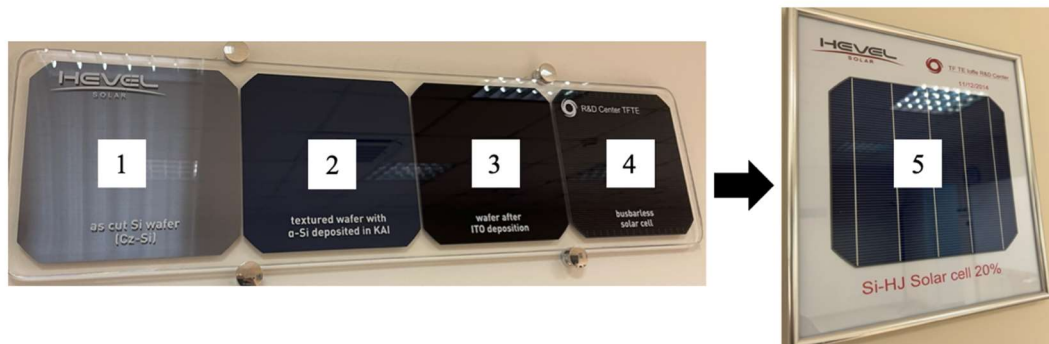
Рисунок 1.26 – Гетероструктурная фотоэлектрическая ячейка (предоставлено ООО «НТП ТПТ»)
