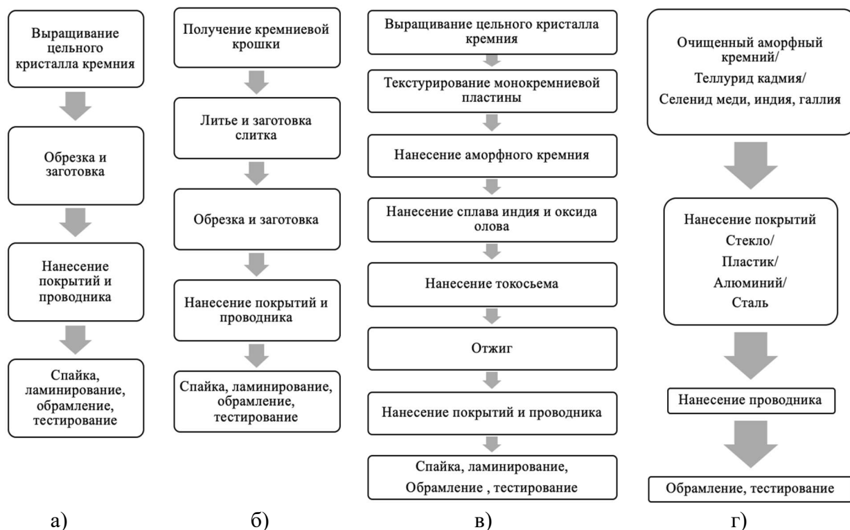
Рисунок 1.22 – Этапы производства исследуемых ФЭП: а) монокристаллическая; б) поликристаллическая; в) гетероструктурная; г) тонкопленочная
