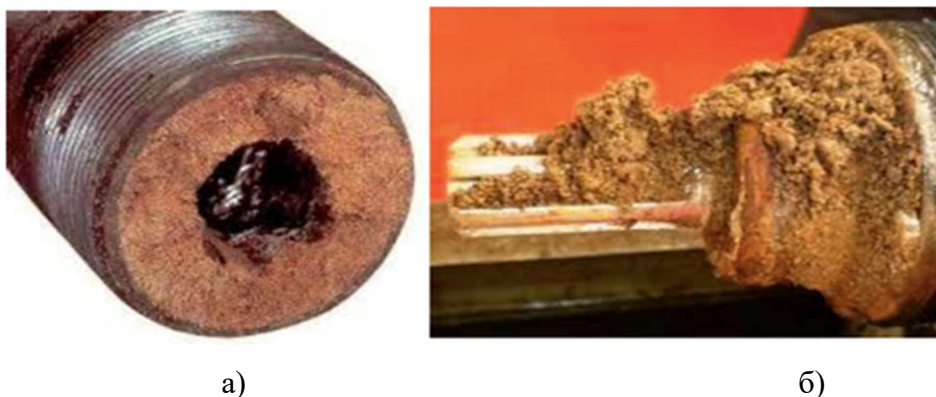
Рисунок 1.3 – Засорение ПО проточной части: а) НКТ; б) электроцентробежный насос (ЭЦН)
