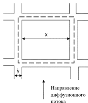
Рисунок 5 - Расчётная схема к вычислению суммарного диффузионного потока (предполагается, что угольные отдельности имеют кубическую форму и одинаково ориентированы, а диффузионный поток перпендикулярен грани угольной отдельности)
