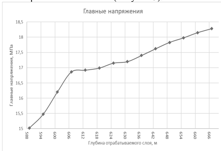
Рисунок 3 – Зависимость изменения главных напряжений на границе очистных работ
