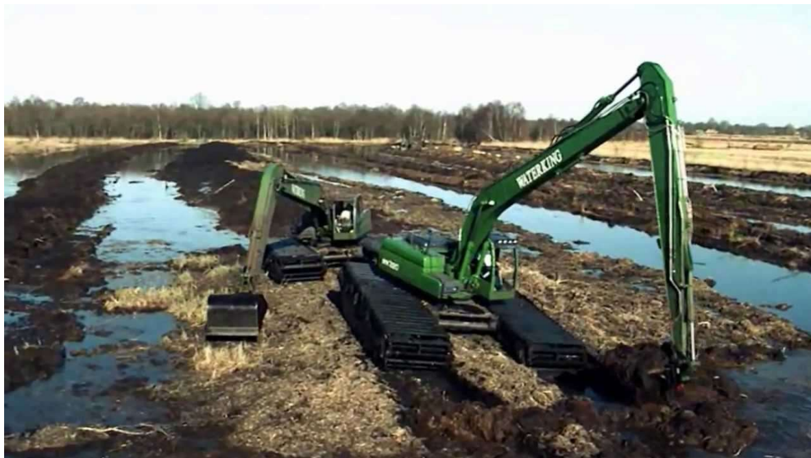
Рисунок 1.13. Пример экскаватора с удлиненной стрелой и специальными широкими гусеницами [27]
