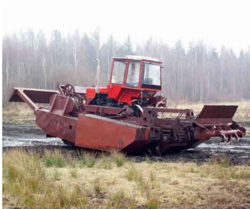
Рисунок 1.12 – Рабочее положение малогабаритного шагающего болотохода серии БМШ [46]
