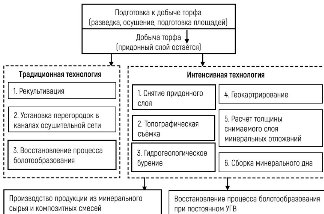
Рисунок 1.19 – Принципиальная схема комплексного использованию ресурсов торфяных месторождений [32]
