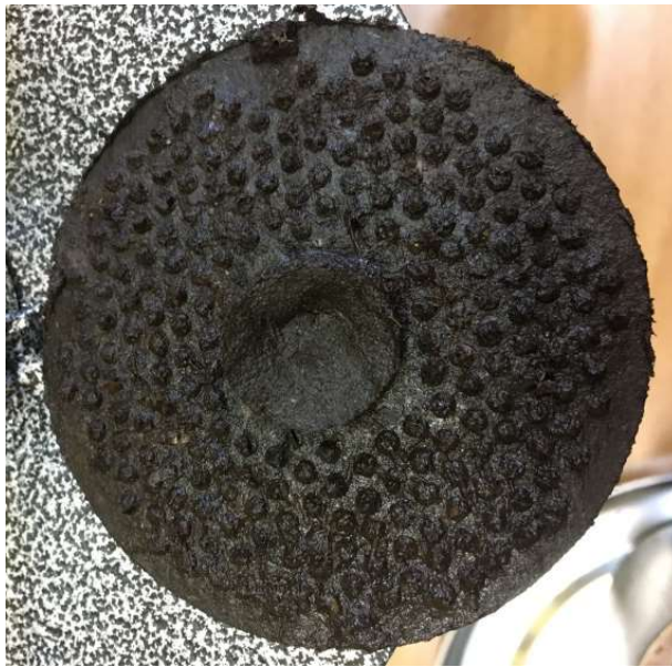
Рисунок 3.17 – Образец торфяной пульпы сразу после обезвоживания в гравитационном прессе
