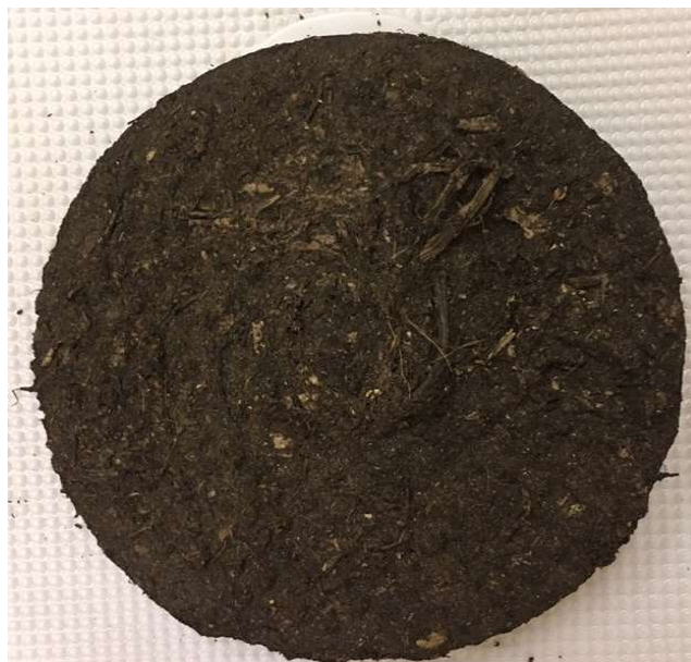
Рисунок 3.18 – Образец торфяной пульпы после нескольких дней сушки на открытом воздухе после обезвоживания в гравитационном прессе
