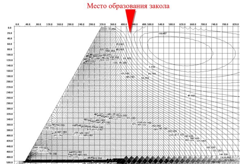
Рисунок 8 – Распределение деформаций сдвига (МПа, угол откоса 60°)
