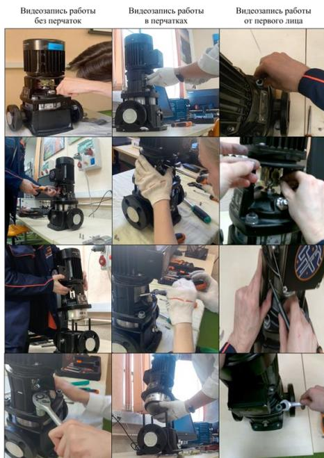
Рисунок 2 – Выполнение ТОиР центробежного насоса в лабораторном эксперименте
