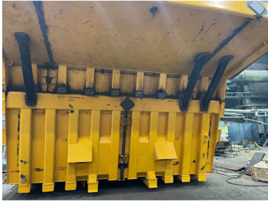
Рисунок 12 – Модернизация кузова автосамосвала с целью увеличения надежности кузова собственными силами предприятия
