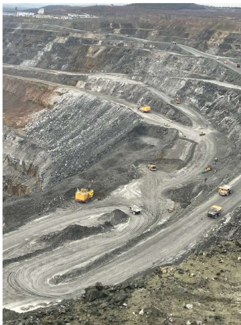
Рисунок 20 – Проведение вскрышных работ
