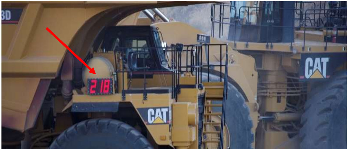
Рисунок 16 – Табло с информацией о текущей массе горной породы в кузове автосамосвала.
