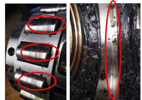
Рисунок 11 – Дефектный подшипник качения синхронного генератора: а) дефекты роликов; б) дефекты внешней обоймы
