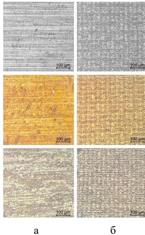
Рисунок 2.5 – Поверхность металлических пластин: а – до лазерной обработки, б – после лазерной обработки. Сверху вниз: Д16, Л63, 08Х18Н10Т. х10
