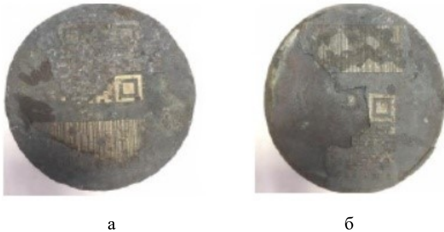
Рисунок 1.3 – Стальная заготовки с окалиной, на которые нанесены маркировки лазерной системой мощностью 50 Вт: а – время маркировки 20 сек; б – время маркировки 40 сек [66]
