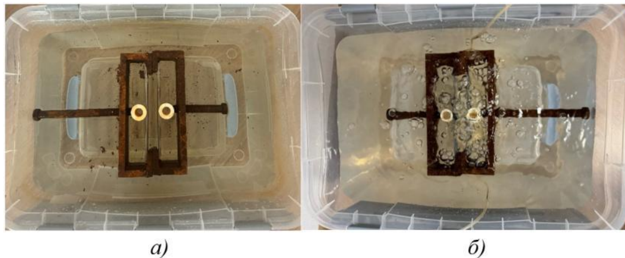
Рисунок 2 – Вид сверху струбцин с образцами в емкости с коррозионной средой в исходном состоянии до продувки (а) и с продувкой (б) воздухом в процессе испытаний
