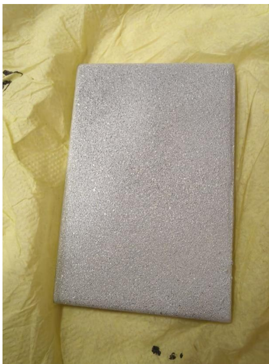
Рисунок 2.4 – Слой Al на поверхности стальной подложки (фото автора)
