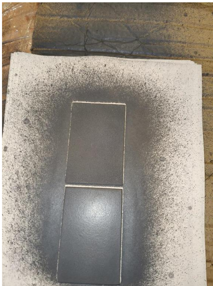
Рисунок 2.11 – Результат покраски образцов (фото автора)
