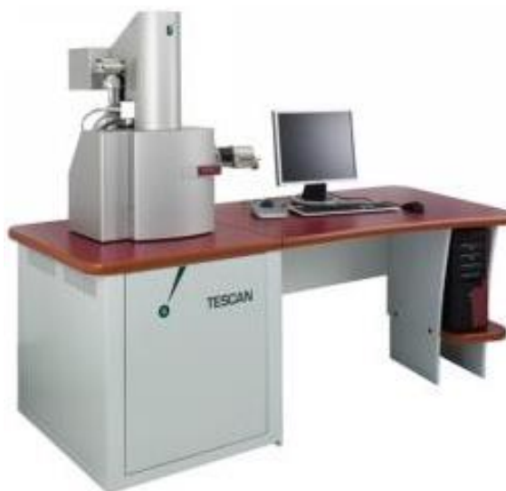
Рисунок 2.5 – СЭМ Tescan Mira 3 [30]
