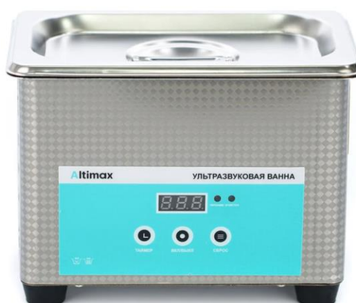
Рисунок 2.8 – УЗ-ванна (фото автора)
