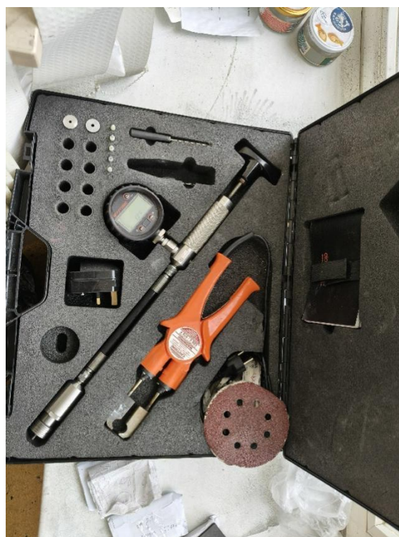
Рисунок 2.17 – Набор для измерения адгезии (фото автора)
