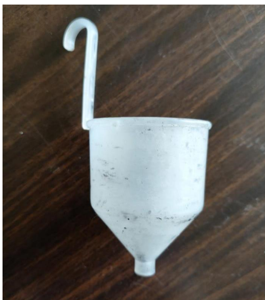
Рисунок 2.6 – Вискозиметр (фото автора)
